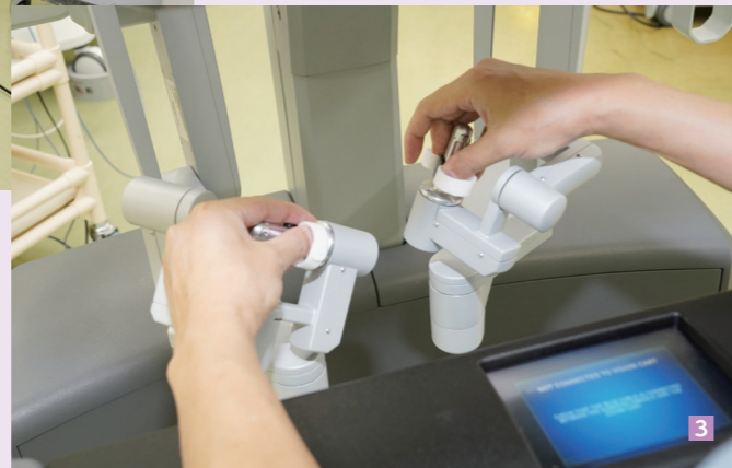
2 術者は操作台のモニターに映る3次元画像を見ながらロボットを操作して手術を行います。手術スタッフは外部モニターに映る映像を見ながらサポートを行います。
