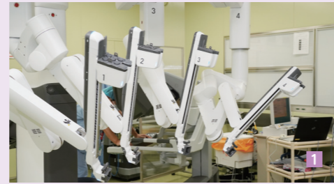
1 4本のロボットアームと内視鏡カメラを体表の1~2cmの小さな穴から体内に挿入します。
