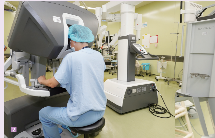
2 術者は操作台のモニターに映る3次元画像を見ながらロボットを操作して手術を行います。手術スタッフは外部モニターに映る映像を見ながらサポートを行います。
